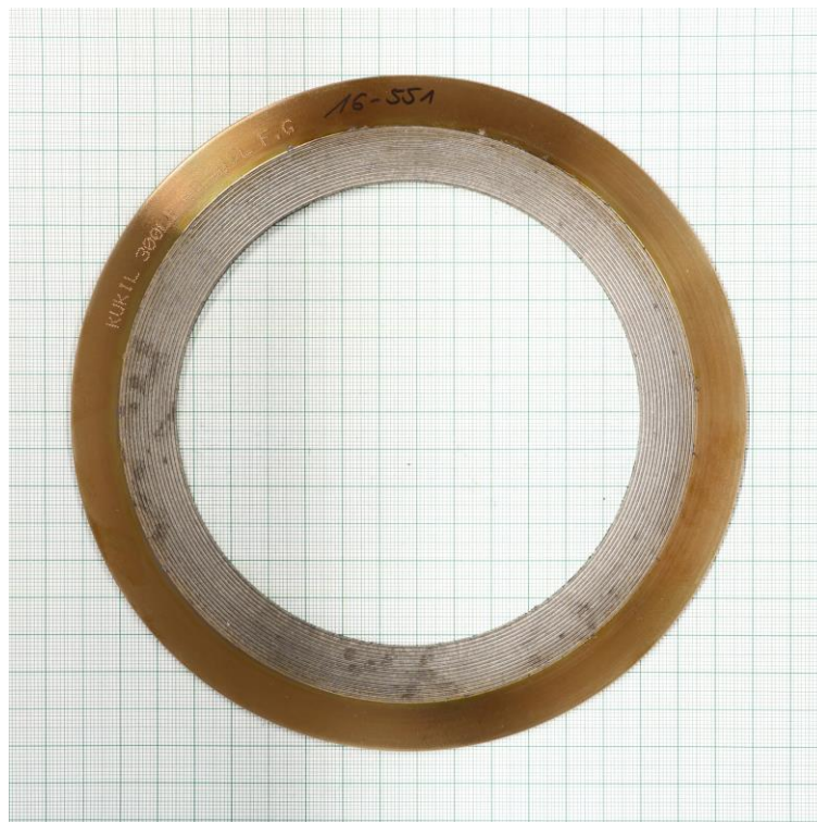
Creep relaxation test at 90 MPa – 400 °C (EN 13555)
