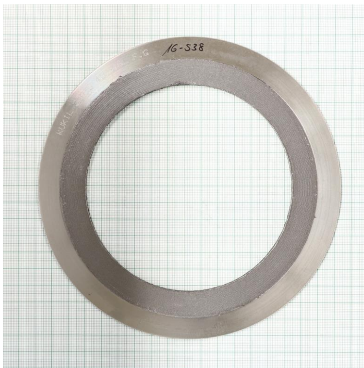
Creep relaxation test at 90 MPa - RT (EN 13555)
