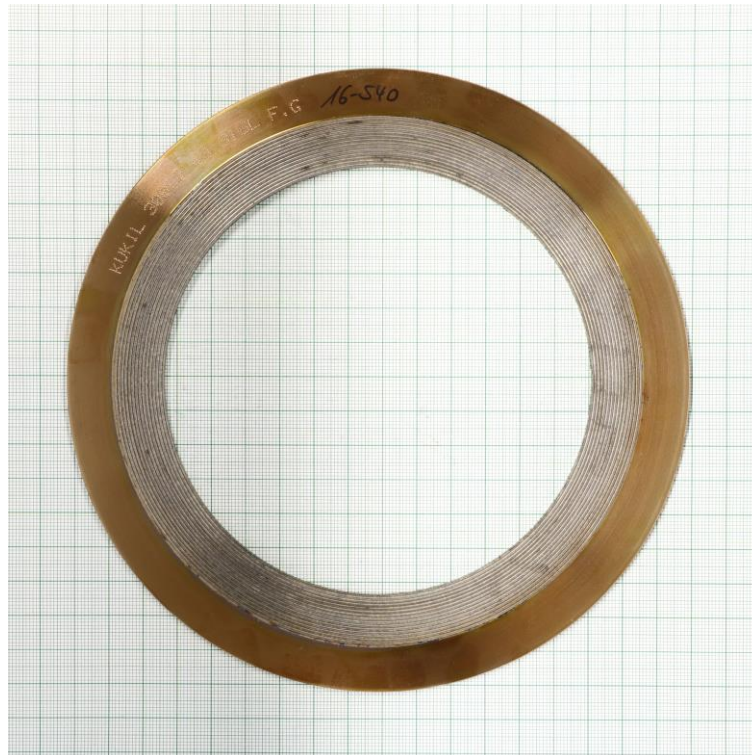
Creep relaxation test at 90 MPa - 400 °C (EN 13555)
